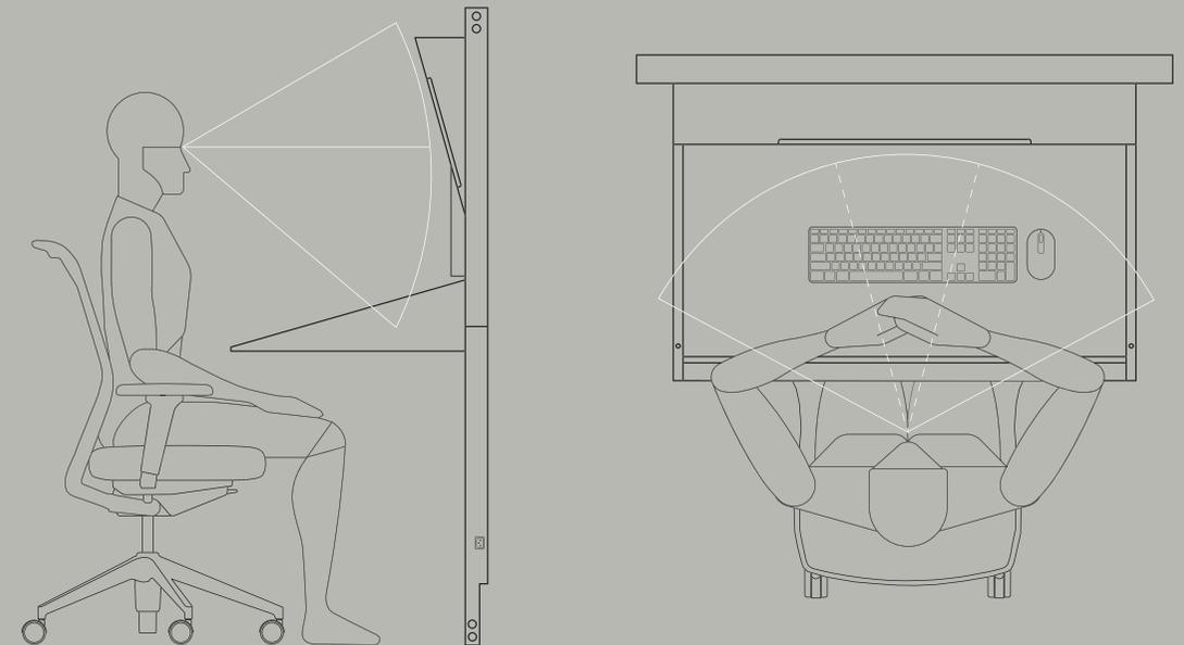
El plano vertical de BEAKTOR favorece el confort acústico, térmico y lumínico al incorporar corcho multiperforado y una iluminación directa difusa con un alto índice de reproducción cromática (CRI>90).
