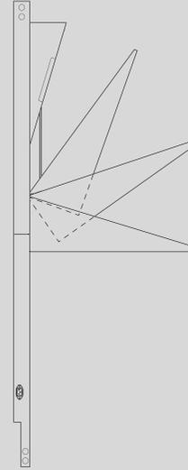
El marco de madera incorpora en ambos lados un mecanismo para amortiguar la apertura en el momento de desplegar la superficie de trabajo.
