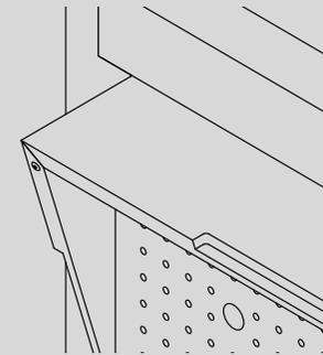
El marco y la carcasa llevan incorporado un sistema de cierre magnético que al abrir o cerrar permite a las partes articuladas permanecer fijas, aportando seguridad y simplicidad durante el proceso de montaje y uso diario.
