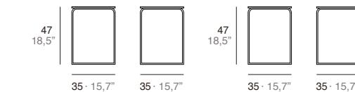
**ES** • Estructura de tubo metálico barnizada transparente brillante al horno, donde se aprecian los efectos causados por la elaboración y soldadura, resaltando así su efecto artesanal. Sobre de mesa en mosaico hidráulico o en madera natural de roble o nogal. Estantes en madera de roble o nogal.
