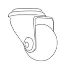
Para un movimiento rotatorio del SITA se ofertan otro tipo de ruedas de 35mm de diámetro que aumentan 52mm la altura total.
