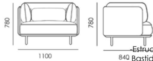
Estructura metálica desmontable. Pies metálicos macizos. Suspensión de asiento mediante cinchas elásticas de gran calidad. Cojines asiento, respaldo y riñonera compuestos por espuma varias densidades libres de CFC recubiertos por Dacrón siliconado. Totalmente desenfundable
