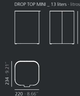
Papelera con capacidad de 13 litros. Fabricada en acero galvanizado y pintada con pintura en polvo termoendurecida lacada al horno. Como todas las papeleras de su serie, incluye un aro interior de acero galvanizado que sujetla la bolsa.
